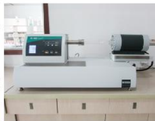
热膨胀系数测试仪
