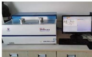
泡压法膜孔径分析仪
