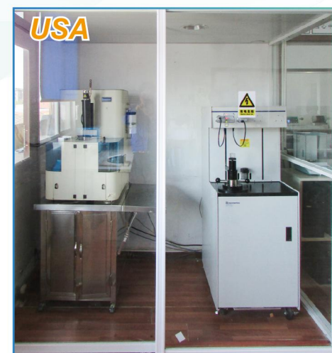
Mercury pressure meter 全自动压汞仪
